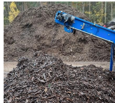
HDS-S separierte Leichtfraktion
