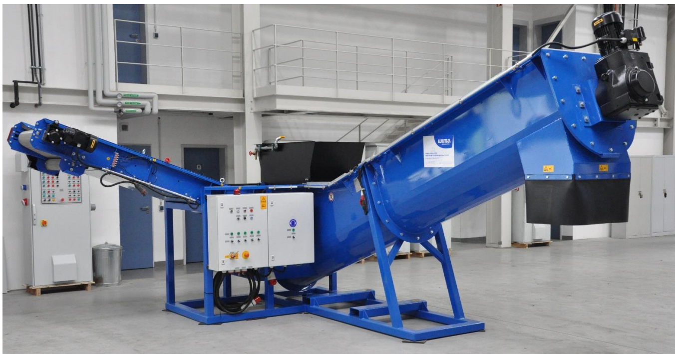
HDS-S Ansicht Schneckenförderer, Schaltschrank und Austragsband
