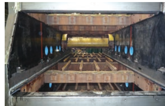
Generalüberholung einer Siebmaschine vom Typ FKP 1550-3 (links: nach Einbau neuer Seitenwände; rechts: Probelauf)
